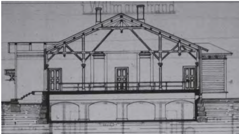
Kuva: Alun perin katon puuristikkorakenne jäi osittain esille ja antoi luonnetta sali-interiöörille. /Artellin leikkauspiirustus 1889. KA
